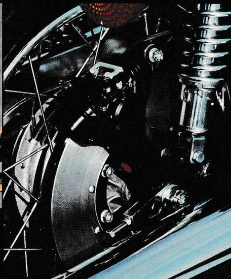
Die hydraulische Scheibenbremse hinten erhöht die Fahrsicherheit. Die Bremsbeläge können durch ein Sichtfenster jederzeit kontrolliert werden.
