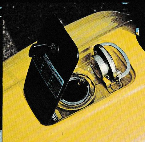
Der Tankdeckel liegt unter einer verschließbaren Abdeckung, die mit dem Zündschlüssel zu öffnen ist.
